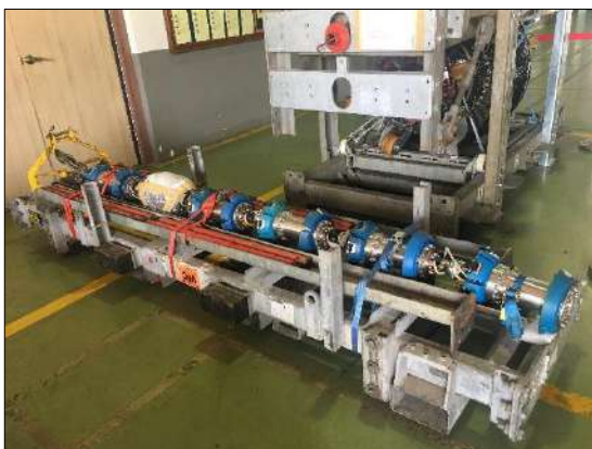
รูปที่ 2-68 การตรวจสอบความหนาของระบบท่อขนส่ง
