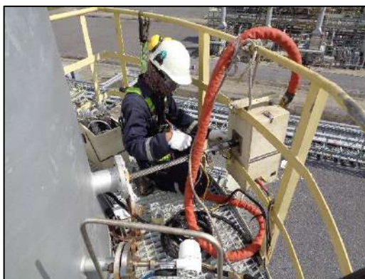
(ค) การติดตามตรวจสอบคุณภาพอากาศจากปล่องระบาย บริเวณ Hot Oil Heater
